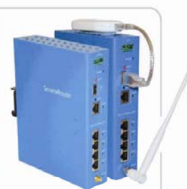
Bild 5: Router als Schnittstelle zu den drahtlos vernetzten Komponenten
