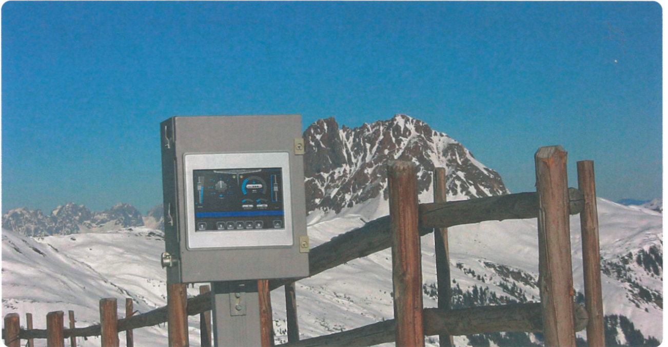
eTOP400 Displays sind auch für den Einsatz im Außenbereich geeignet. Aufgrund des erweiterten Temperaturbereichs, sonnenlichtesbarer Displays und IP69 sind sie vielseitig einsetzbar.
